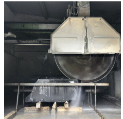
Der größte Teil der Ware wird aus dem Block gefertigt; hier eine der drei Blocksägen bei der Arbeit.
